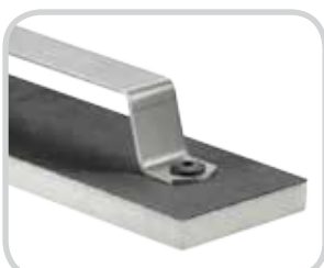
Rohacell-Schaum + CFK-Deckschicht Auszugskraft 1.300-1.700 N
