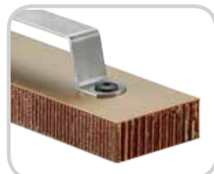
Aramidwabe + Aramidfaser-Deckschicht Auszugskraft 700–1.200 N
