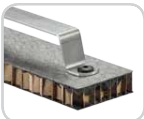
Papierwabe + PUR GF-Deckschicht Auszugskraft 900 N
